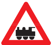
A 72: Jernbaneoverkørsel uden bomme.
